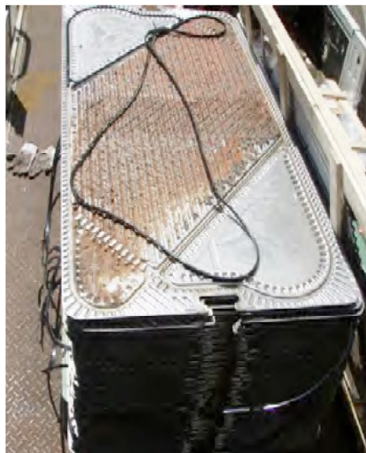
9 mois après l'installation de Vulcan : l'échangeur à plaques démonté pour être nettoyé.
